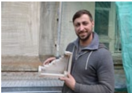
DIESER STUCKSCHLITTEN wurde extra angefertigt für die Stuckarbeiten an einigen Fenstern des Jenaer Volkshauses.
